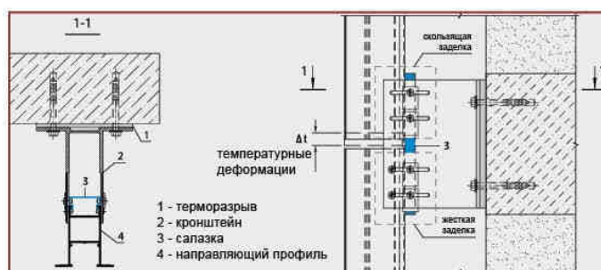
Рис. 2 Опорный блок крепления системы U-kon HIGH
