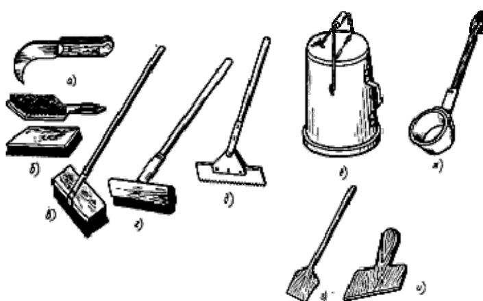
Рис.3. Инструменты и инвентарь, применяемые при устройстве гидроизоляции
