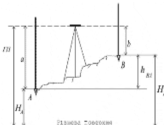
Рисунок 1 - Схема геометрического нивелирования с середины
