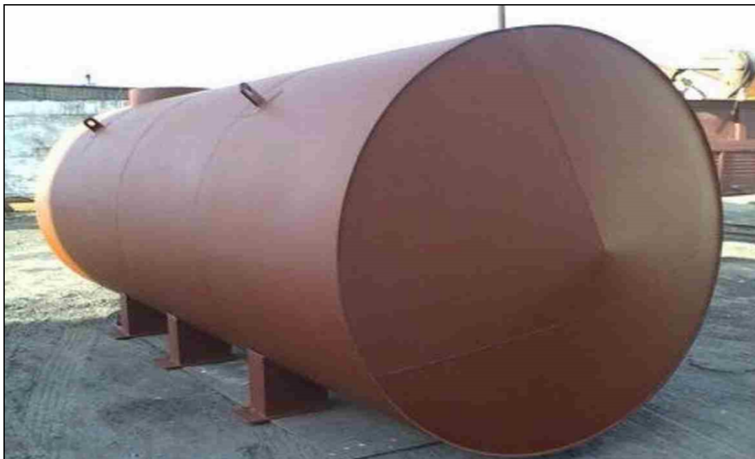
Фото 1. Резервуар, емкостью 40 м 3 , для хранения едких жидкостей. Общий вид.
