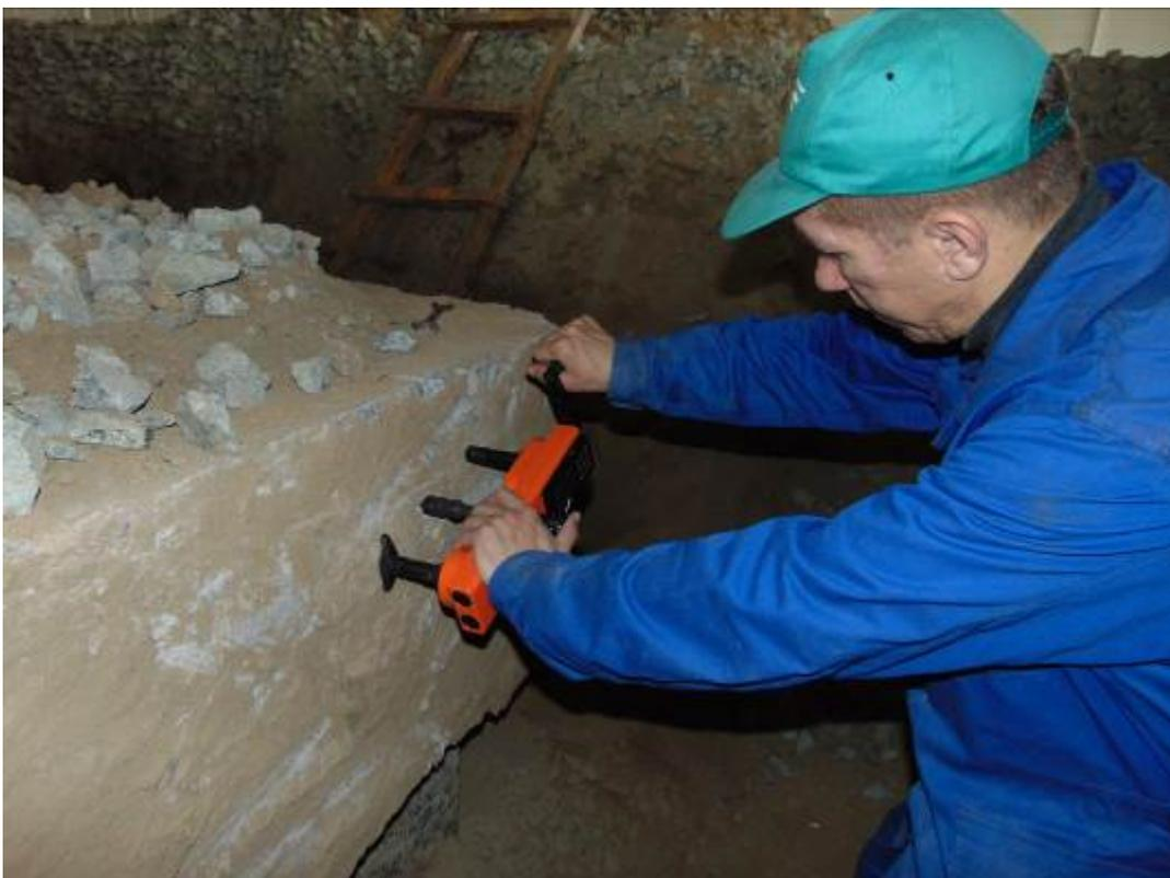
Фото 20. Шурф 1. Производится определение прочности бетона ростверков методом отрыва со скалыванием.
