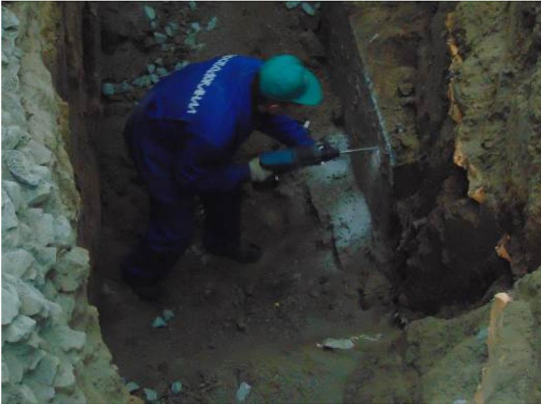
Фото 19. Шурф 1. Производится определение прочности бетона ростверков методом отрыва со скалыванием.
